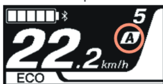
Ukázka zobrazení režimu automatického řazení převodů
