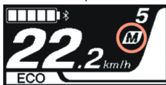
Ukázka zobrazení režimu manuálního řazení převodů
