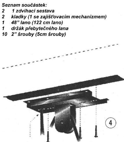
4. Pomocí přiložených šroubů připevněte obě zdvihací sestavy (3-4 šrouby na každou) na stropnici (obr. 4a) a zajistěte je tak, aby háky korespondovaly s naměřenou vzdáleností mezi řidítky a sedlem (výtah bude fungovat lépe, pokud byla vzdálenost změřena přesně). Předvrácení otvorů Vám usnadní práci. Provlékněte lano přes kladky (obr. 4b). Provlékněte lano skrz obě části zajišťovacího mechanizmu (obr. 4c).
